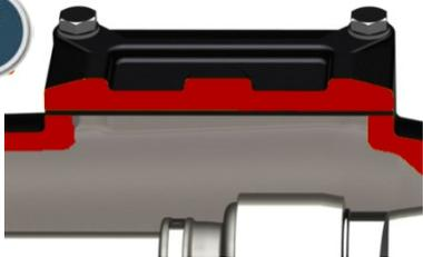
Les corps de pompe dans la version en fonte ont une porte de visite largement dimensionnée, particulièrement utile dans le domaine de l'épuration et du biogaz, pour le nettoyage et l'entretien de la pompe à l'entrée du stator.
