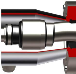
Le manchon de protection de l'articulation offre une surface de contact minimale avec le produit et se trouve dans une position peu exposée à d'éventuels corps solides et / ou tranchants. La technique particulière d'assemblage avec la bague de protection de l'articulation en acier inoxydable, assure non seulement la parfaite étanchéité de l'articulation à haute pression, mais élimine l'utilisation d'une seconde partie, généralement très sollicitée dans les solutions habituellement adoptées.
